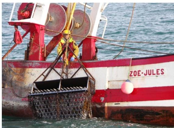
Tractée par un navire sur des fonds meubles ou caillouteux à l'aide d'une fune manœuvrée par un treuil, la drague à coquilles Saint-Jacques est une sorte de **râteau** muni à l'arrière d'un **sac en anneaux d'acier**. Les dents positionnées sur l'ouverture permettent de ratisser la surface du substrat pour attraper le bivalve.
