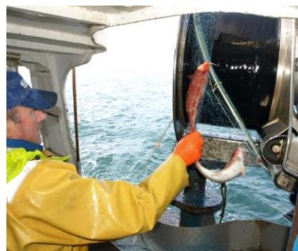
Relevage des filets grâce au vire-filet.
