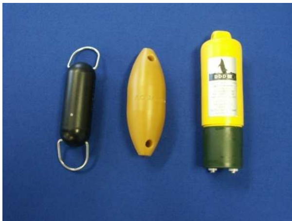
Les modèles de pingers testés lors de l'étude. De gauche à droite : pinger V02, Aquamark 100 et DDD02.
